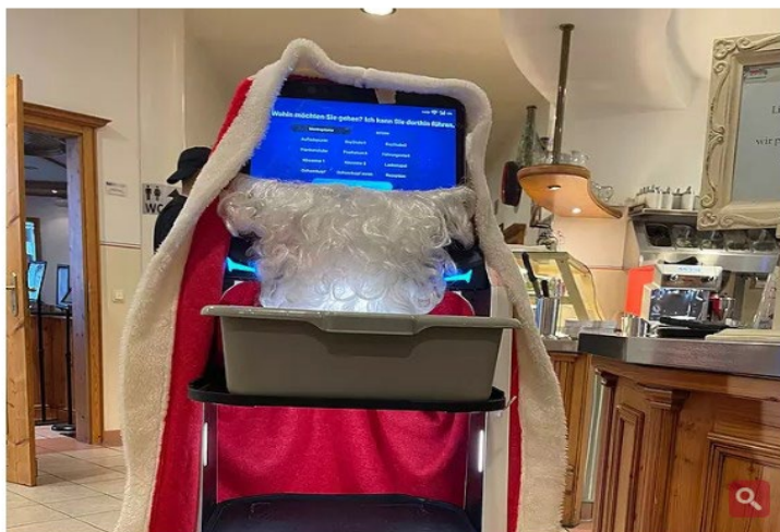
Der Serviceroboter kann mehrere Tablets auf einmal transportieren und so dem Personal Laufwege abnehmen. // Foto: Jürgen Gärtner
